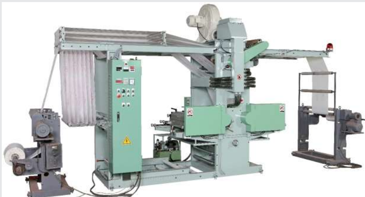
ДВУХЦВЕТНАЯ ФЛЕКСОГРАФИЧЕСКАЯ ПЕЧАТНАЯ МАШИНА ДЛЯ НАНЕСЕНИЯ ЛОГОТИПА НА РУКАВНУЮ ПОЛИЭТИЛЕНОВУЮ ПЛЕНКУ В ЛИНИЮ.
