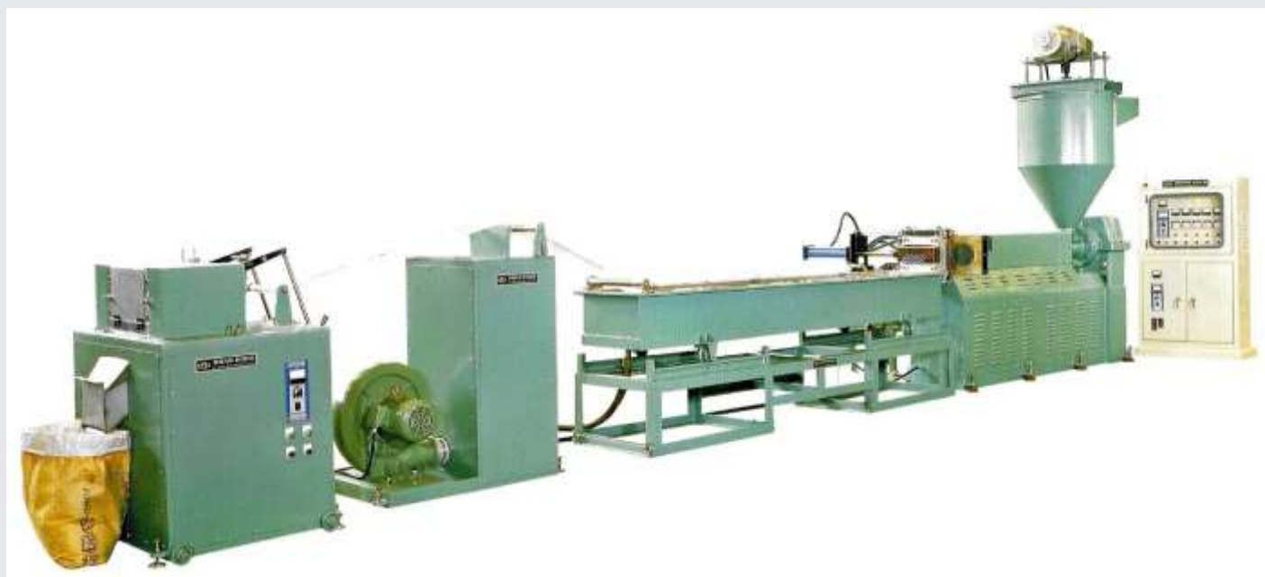
ЛИНИЯ ПО ПЕРЕРАБОТКЕ ПЛАСТИКОВЫХ ОТХОДОВ (РЕ/РР пленка, пакеты, мешки).
